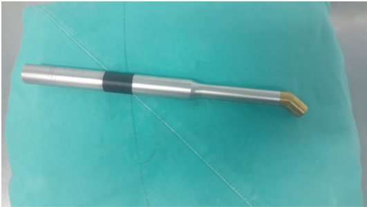
Şekil 2. ROLL tekniğinde kullanılan kablolu gama prob cihazı
